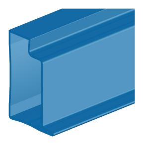
I traversi metallici sono tutti costituiti da tubi a sezione rettangolare 40x80x2 mm in acciaio UNI EN 10025-S275JO con le seguenti caratteristiche:
